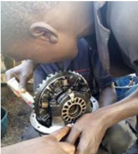
*Beim Zerlegen eines Getriebes.*
